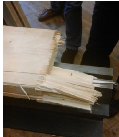
Abbildung 7 Quellen eines Brettschichtholzelementes (links) und Bruch einer Keilzinkenverbindung nach Biegeprüfung (rechts)
