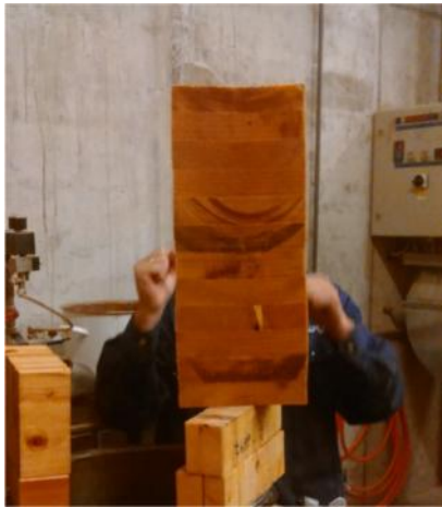
Abbildung 7 Quellen eines Brettschichtholzelementes (links) und Bruch einer Keilzinkenverbindung nach Biegeprüfung (rechts)
